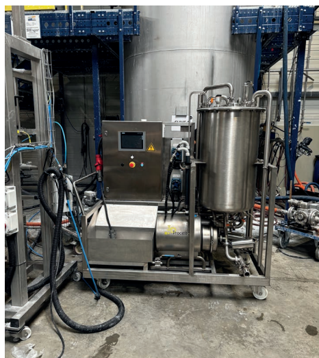
Mise en route de la machine NEP de nettoyage des cuves.
